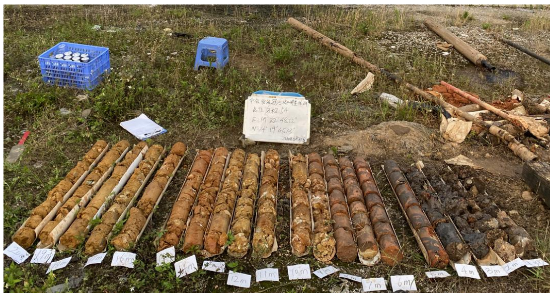
图 3.3-4 54#点原木材防腐厂生产车间处土壤采样照片
