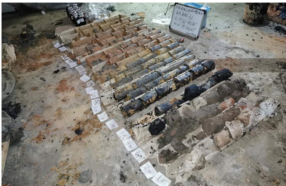
图 3.3-3 32#点原木材防腐厂污水处理站处土壤采样照片
