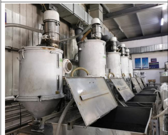
项目注塑生产线投料、干燥区现状照片
