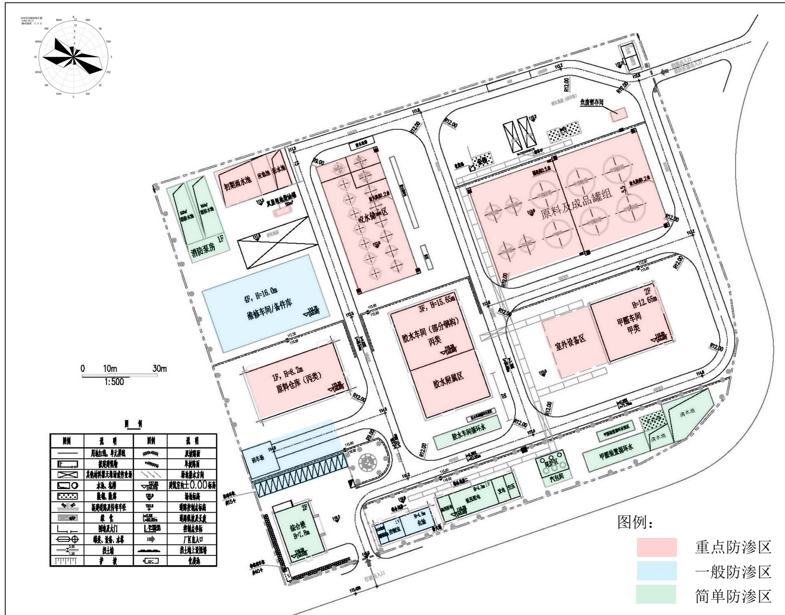
附图 4 项目厂区地下水污染防渗分区图
