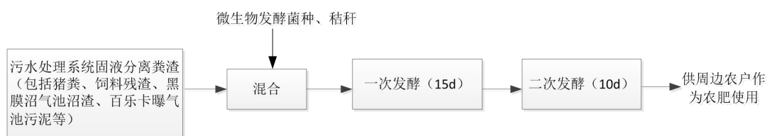
图2.2-12 项目粪渣等固体废物处理工艺
