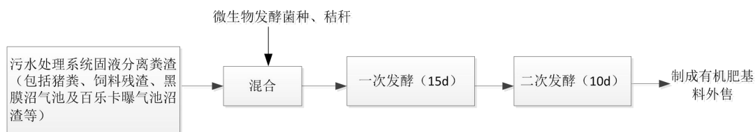
图2.2-11 项目粪渣等固体废物处理工艺
