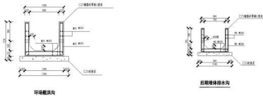
图 2.2.6-8 飞灰填埋区截洪沟结构图
