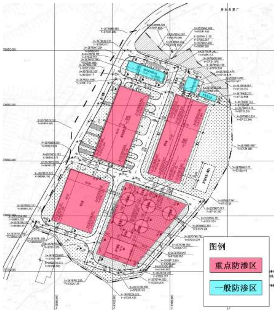
图 5.2.3-2 渗滤液处理厂分区防渗示意图
